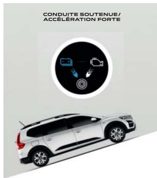
LES MOTEURS THERMIQUE ET ÉLECTRIQUE FONCTIONNENT SIMULTANÉMENT
